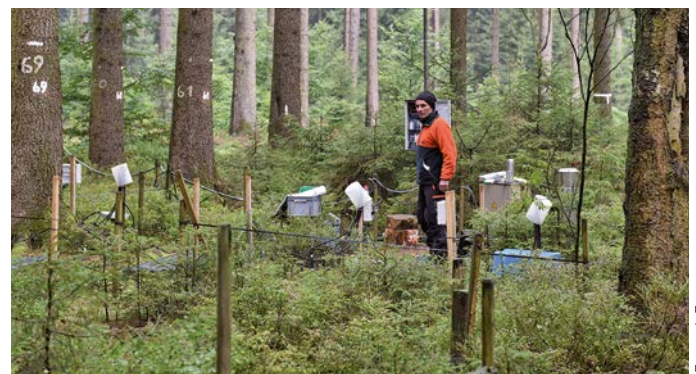
Bodenhydrologisches Messfeld auf einer Level II-Fläche
